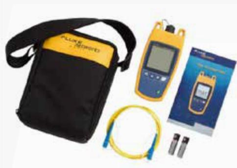
Fiber OneShot™ PRO es su herramienta de solución de problemas de fibra monomodo más rápida para localizar curvaturas excesivas, empalmes con grandes pérdidas, roturas y conectores sucios en fibra monomodo a más de 23.000 metros diagnosticados en menos de cinco segundos.
