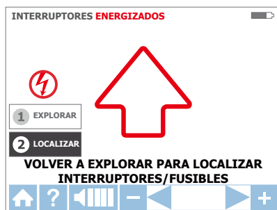
Figura 3.3d: Modo UBICACIÓN – Búsqueda de los disyuntores/fusibles correctos
