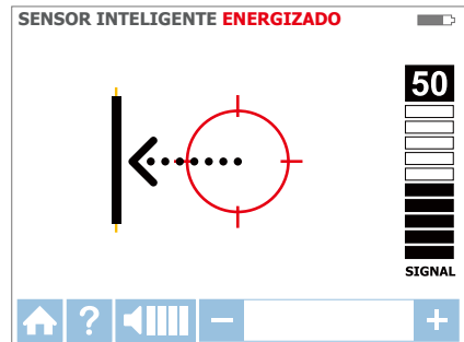
Figura 3.1e: Cable a la izquierda
