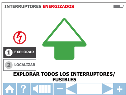
Figura 3.3c: Modo LECTURA – Lectura de disyuntores/fusibles
