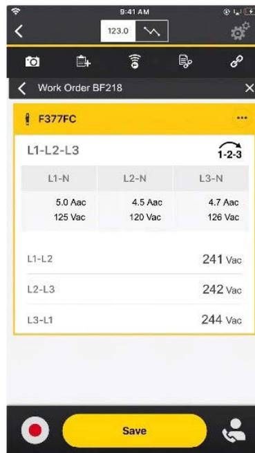
Fluke Connect toma todos los datos relacionados con las medidas trifásicas, incluida la rotación de fases, y le presenta todo el conjunto de datos para que pueda analizarlos de un vistazo.
