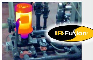
La pantalla táctil LCD de 3,5 pulgadas le ofrece IR-Fusion™, que combina una imagen de luz visible y una imagen infrarroja para localizar problemas con más facilidad. Solo tiene que deslizar el dedo por la pantalla para ajustar la configuración.
