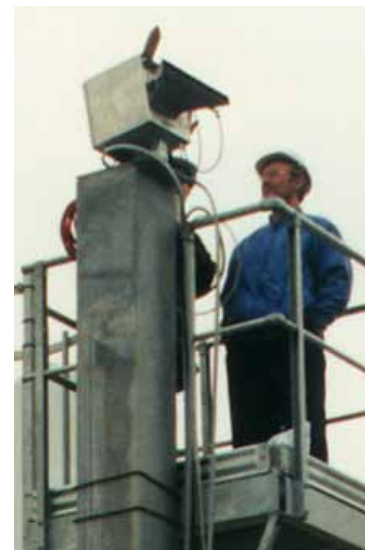
La caja protectora del explorador de líneas se monta en la parte superior de una torre.
